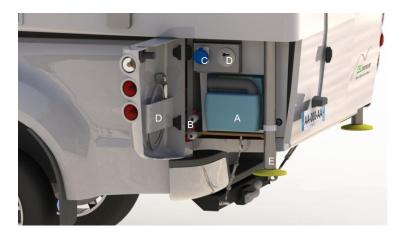
Sur le coté gauche, se regroupent: cassette des toilettes (A), 2 vannes de vidange des réservoirs d'eau (B), prise de raccordement 230V (C), douchette extérieure (D), béquille télescopique (E).
